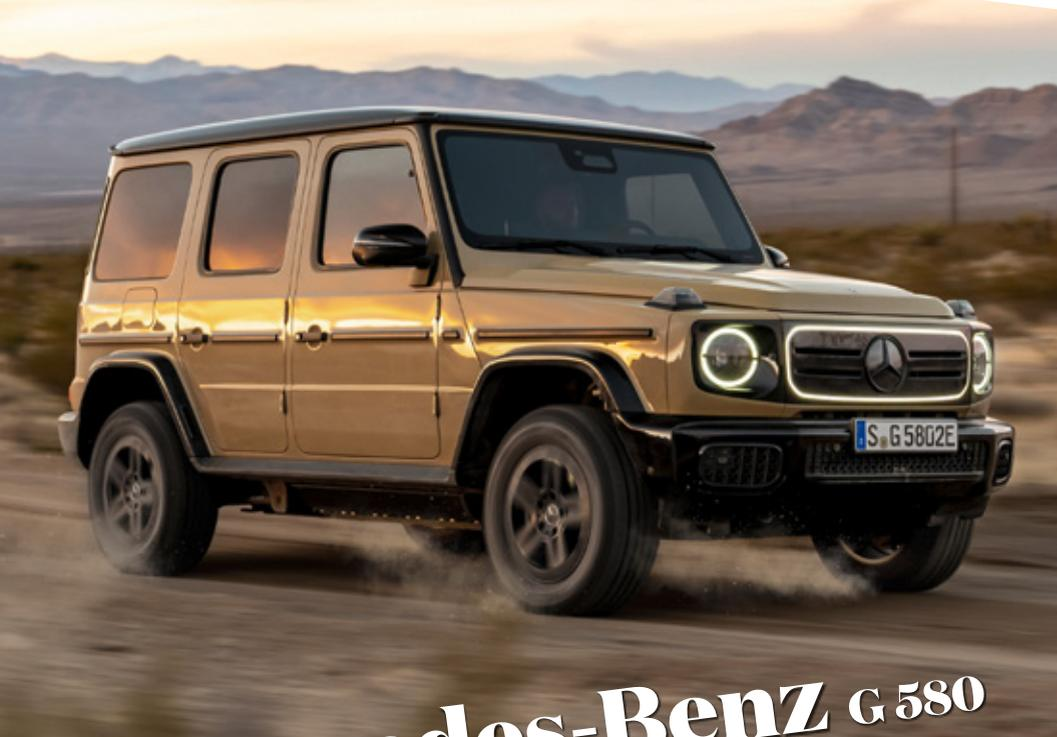
Mit dem neuen Mercedes-Benz G 580 mit EQ Technologie präsentiert Mercedes das erste vollelektrische Modell seiner Offroad-Ikone. Die neue elektrische G-Klasse verkörpert gleichzeitig Tradition sowie Fortschritt. Die vier radnahen, individuell ansteuerbaren Elektromotoren des Geländewagens entwickeln eine maximale Gesamtleistung von 432 kW. Die im Leiterrahmen integrierte Lithium-Ionen-Hochvoltbatterie mit 116 kWh ermöglicht Reichweiten von bis zu 473 Kilometern.
